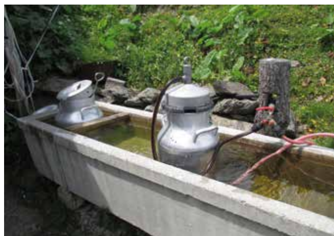
Abbildung 22: Kannendrehkühler (© Josef Mallaun)
