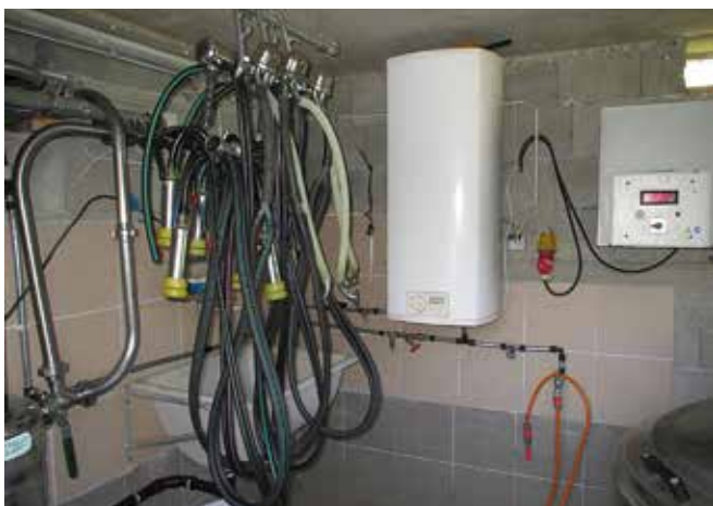
Abbildung 17: Rohrmelkanlage (© Josef Mallaun)
