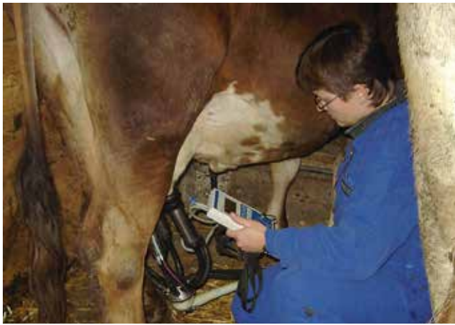
Abbildung 19: Vakuummessung im Anbindestall (© Kathrin Lincke)
