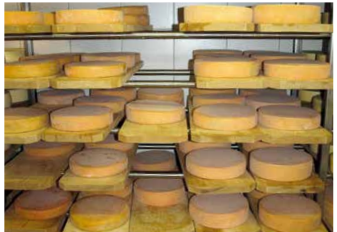
Abbildung 14: Handliche Reifungsbretter und Reifegestelle aus Edelstahl erleichtern die Reinigung (© HBLFA Tirol)
