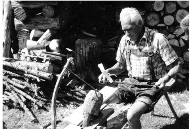
In ländlichen Gebieten war das Holzschindeldach einst weit verbreitet (l.). Mit dem Reifmesser werden die Schindeln auf der „Hoanzlbank“ geputzt und gespranzt (r.).
