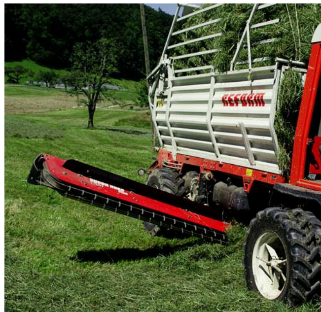
Der Speedrake reht das Heu sauber zusammen (l.). Der Speedrake lässt sich hydraulisch heben und senken (r.).
