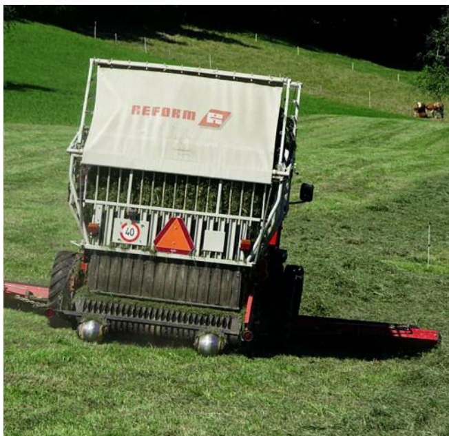
Der Speedrake reht das Heu sauber zusammen (l.). Der Speedrake lässt sich hydraulisch heben und senken (r.).
