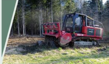
Wurzelstockrodungen: Bagger mit Roderechen und Forstmulcher
