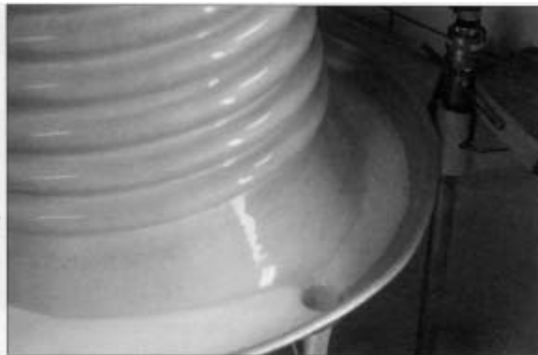
Über eine mit Kaltwasser durchflossene Aluminiumspirale rieselt die Milch
