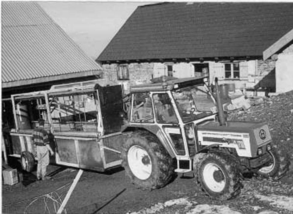
**Der fahrbare Melkstand mit der gesamten Melktechnik wird rückwärts in die Grube eingeschoben**
