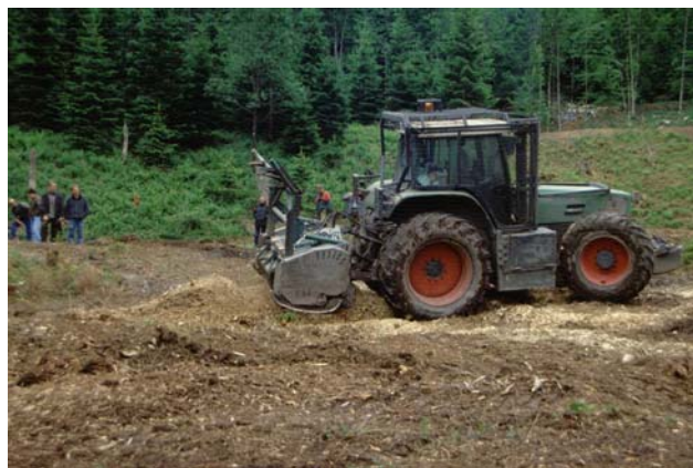
Flächen- und Stockfräsungen mit dem Traktor
